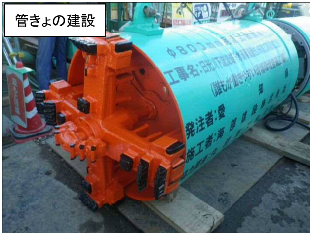
シールド掘進機
